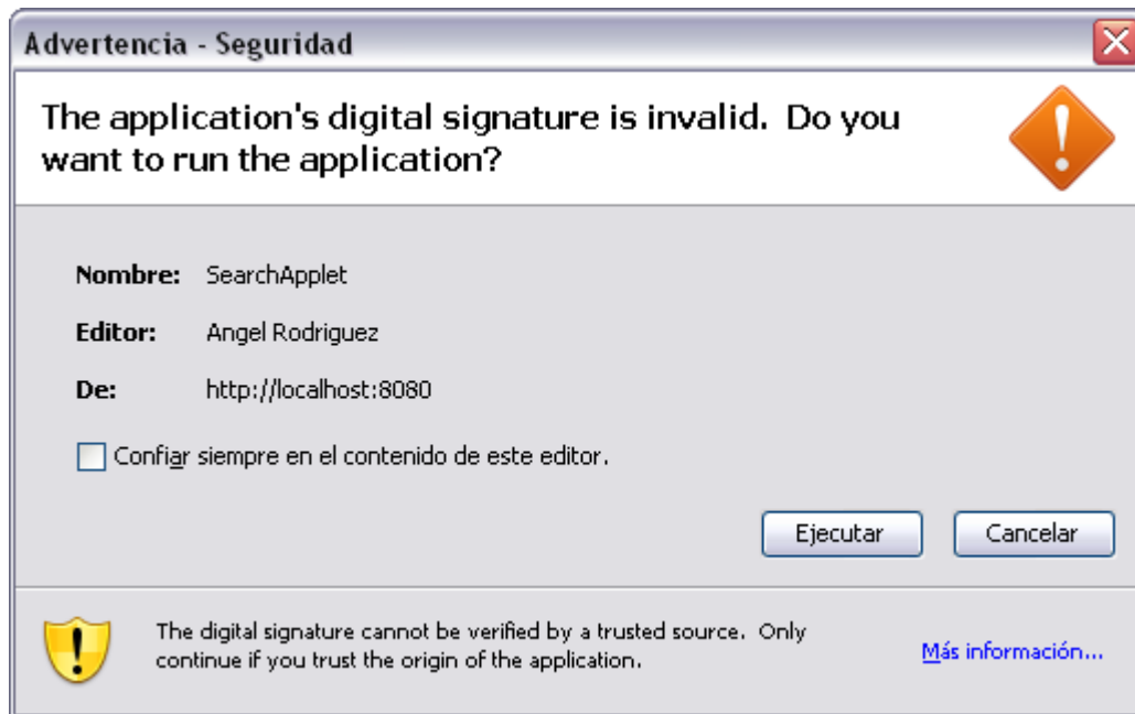
Figura 23. Aviso del navegador Firefox sobre la firma digital del applet. Indica que es inválida ya que no me reconoce como entidad certificadora de confianza
