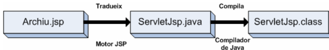
Figura 25: Transformació de JSP a Servlet
