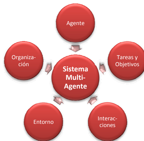
Fig. 3. Meta-modelos de un SMA en INGENIAS
